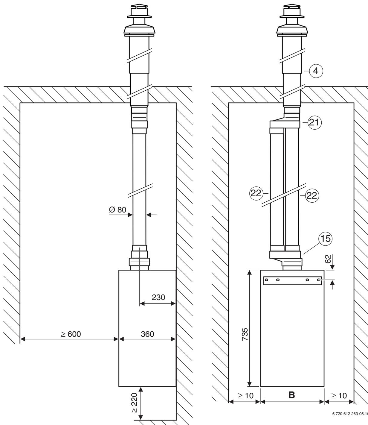
Рис 9 Газоотводный трубопровод в соответствии с С<sub>32</sub>
