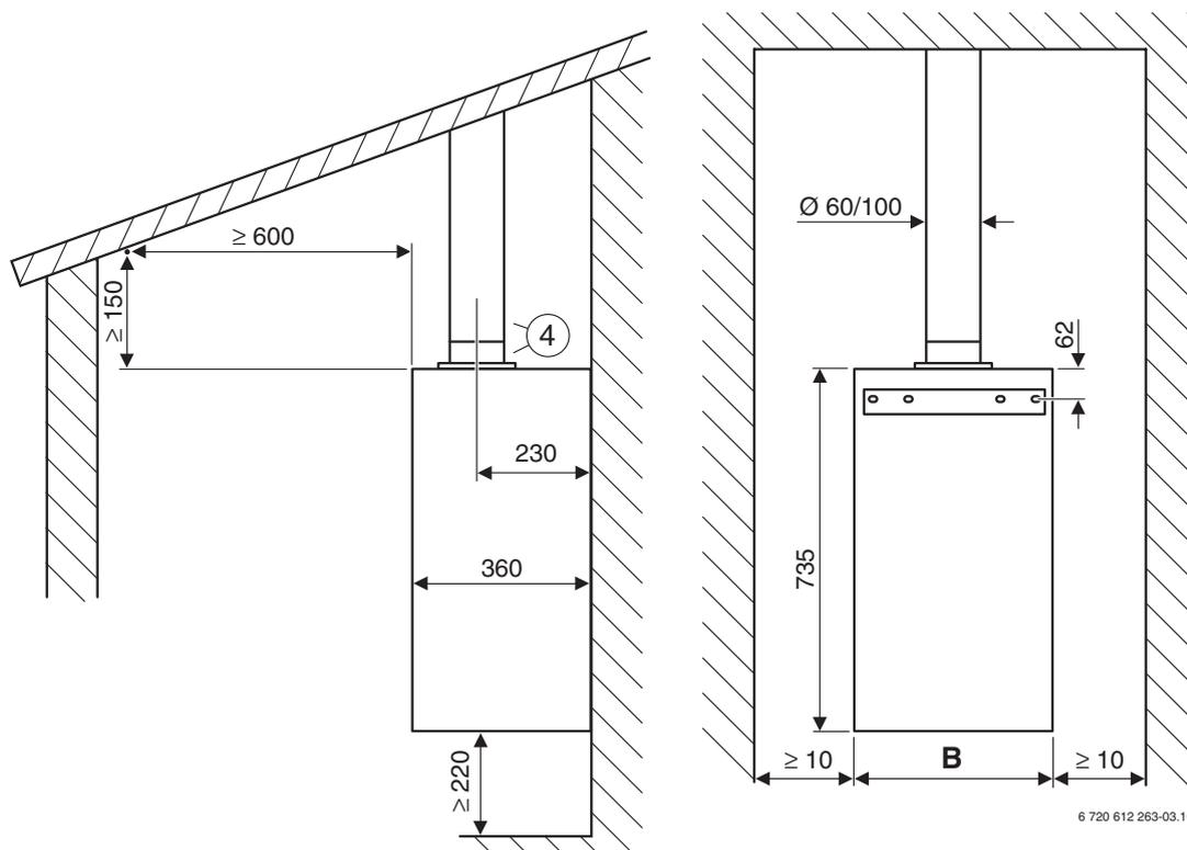
Рис 5 Скатная крыша
