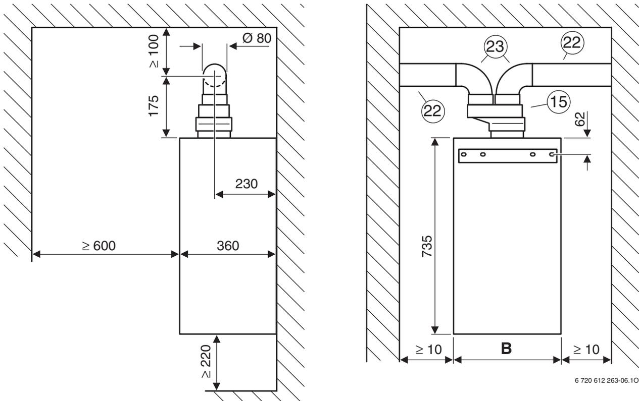
Рис 10 Газоотводный трубопровод в соответствии с C<sub>42</sub>, C<sub>52</sub> и C<sub>82</sub>
