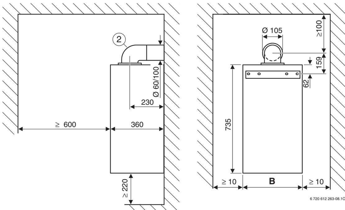
Рис 2 Газоотводный трубопровод в соответствии с C<sub>12</sub>
