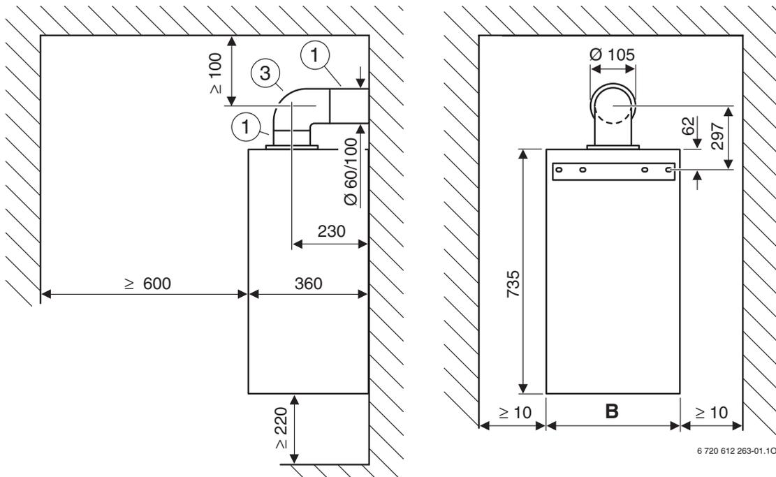
Рис 1 Газоотводный трубопровод в соответствии с C<sub>12</sub>
