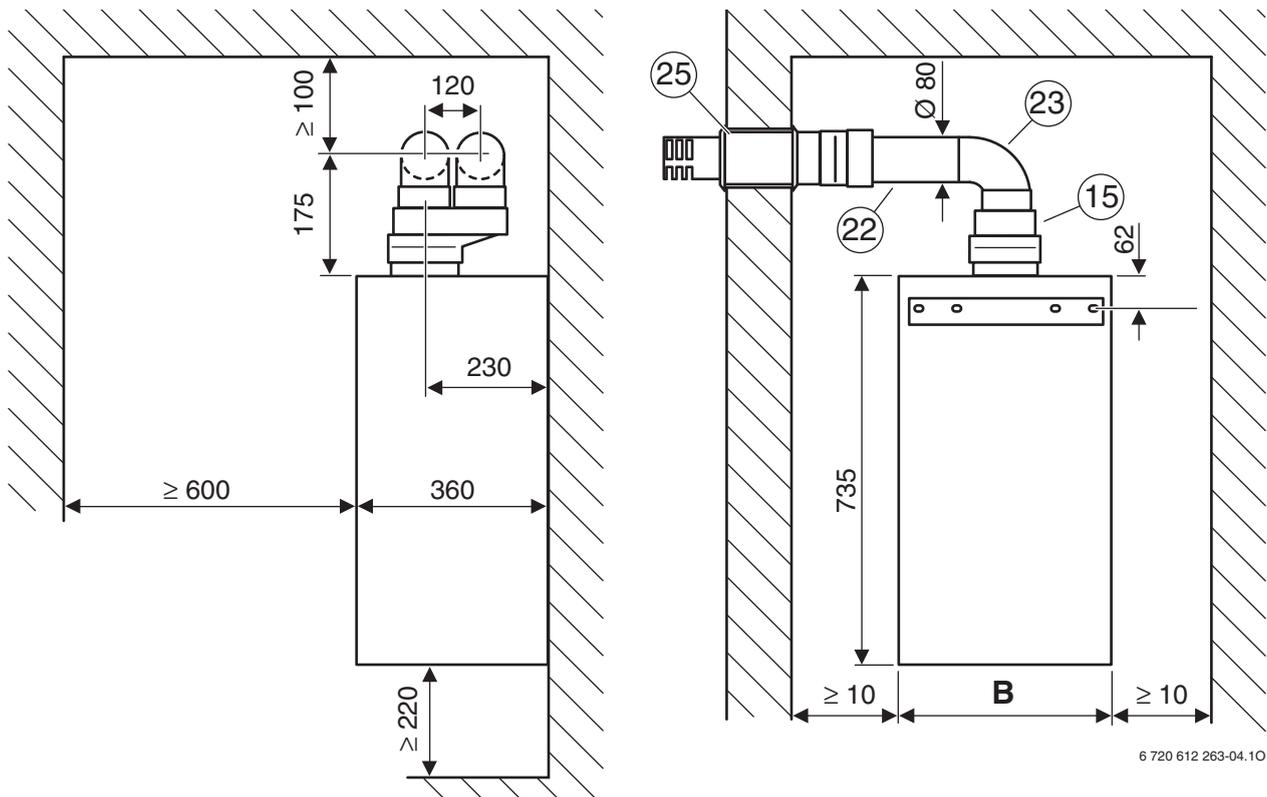
Рис 8 Газоотводный трубопровод в соответствии с C<sub>12</sub>
