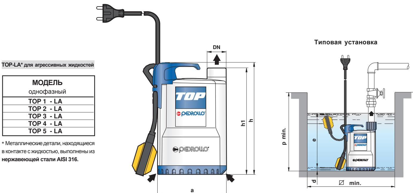
\* Металлические детали, находящиеся в контакте с жидкостью, выполнены из нержавеющей стали AISI 316.
