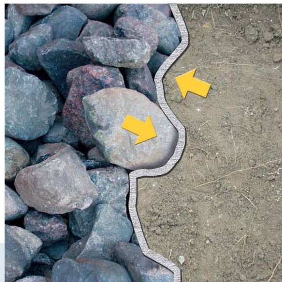
Рис. 8. Большая степень удлинения геотекстильного материала позволяет ему повторять контур неровной поверхности сооружения.
