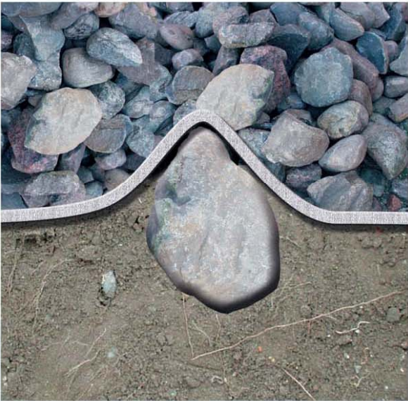
Рис. 3. Большая степень удлинения и высокая статическая прочность на прокол позволяют геотекстильному материалу облегать неровности поверхности.
