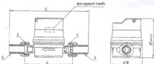
**ВНИМАНИЕ** ВО ИЗБЕЖАНИИ СРЫВА ФИКСИРУЮЩЕЙ ПЛОМБЫ С ДАТЧИКА ИМПУЛЬСНОГО НИЗКОЧАСТОТНОГО ВРАЩЕНИЯ СЧЕТНОГО МЕХАНИЗМА ПРОИЗВОДИТЬ ТОЛЬКО ЗА ПРОЗРАЧНЫЙ ЗАЩИТНЫЙ КОЖУХ.
